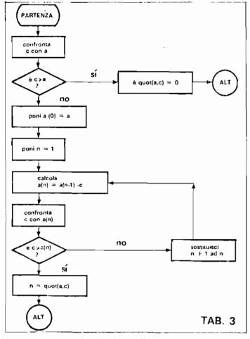
In questa seconda maniera di vedere il calcolo di quot (a. c) potrebbe essere ottenuto con un procedimento la cui programmazione è data dal diagramma di flusso di Tab. 3.
